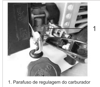
1. Parafuso de regulagem do carburador
