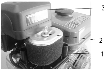
1. Filtro Completo 2. Rosca Borboleta 3. Tampa do filtro de ar
