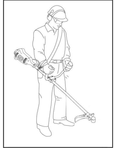
Escolha o acessório mais adequado ao serviço a ser efetuado e instale-o na roçadeira, ligue a máquina e pratique os movimentos de corte antes de iniciar o trabalho. Organize a área de trabalho. Sempre deixe a extensão para trás da máquina, pois a mesma poderá ser cortada pela lâmina se ficar na faixa de trabalho, com risco de grave acidente, não trabalhe com extensão enrolada.
